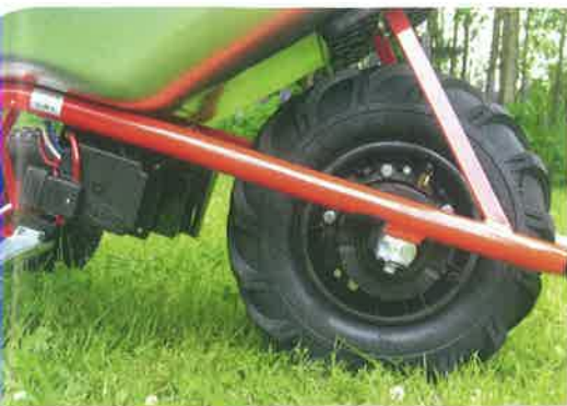
↑ Mobarrown akku on suojaassa koteloituna kupan alla. Moottori ja voimansiirtopaketti on rakennettu pyörän napaan.
